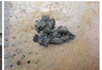
写真20 脱脂綿の焼損状況
