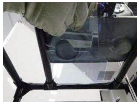
写真8 未燃焼ガスの発生状況
