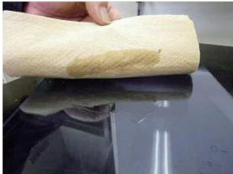
写真11 液化した灯油の付着状況1
