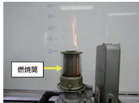
写真7 異常燃焼の状況
