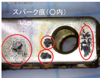
写真7 プラグ刃表面のスパーク痕
