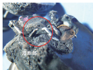
写真11 コイル3の溶解部
