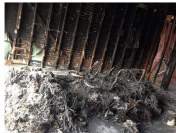
CFRPをボディにした車両の焼損状況 (参考資料3-7-17)
