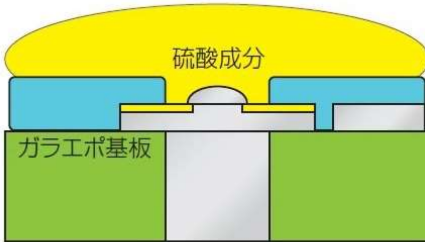
図6 銅箔部分と硫酸成分の反応が始まる
