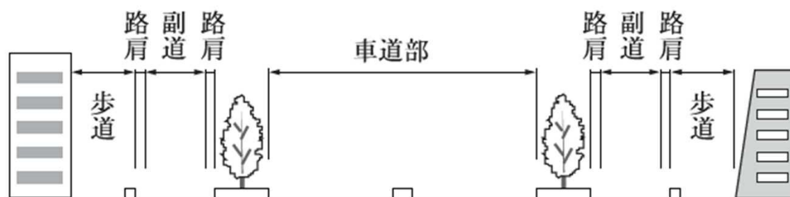
図 副道の構造
